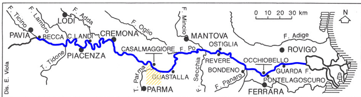
Figura 1 – Tratto del Fiume Po dal Ticino al Delta, preso in esame per documentare le rotte storiche avvenute nella sua arginatura maestra a partire dal 1800; il riquadro indica il settore parmense da sottoporre a indagini di dettaglio per individuare le aree inondate a seguito delle rotte.
